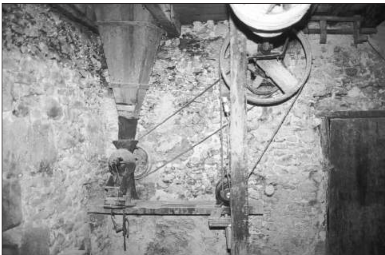
Igartzako Errota. Zakuak betetzeko polea transmisioa. / Transmisión de poleas para llenar los sacos.
