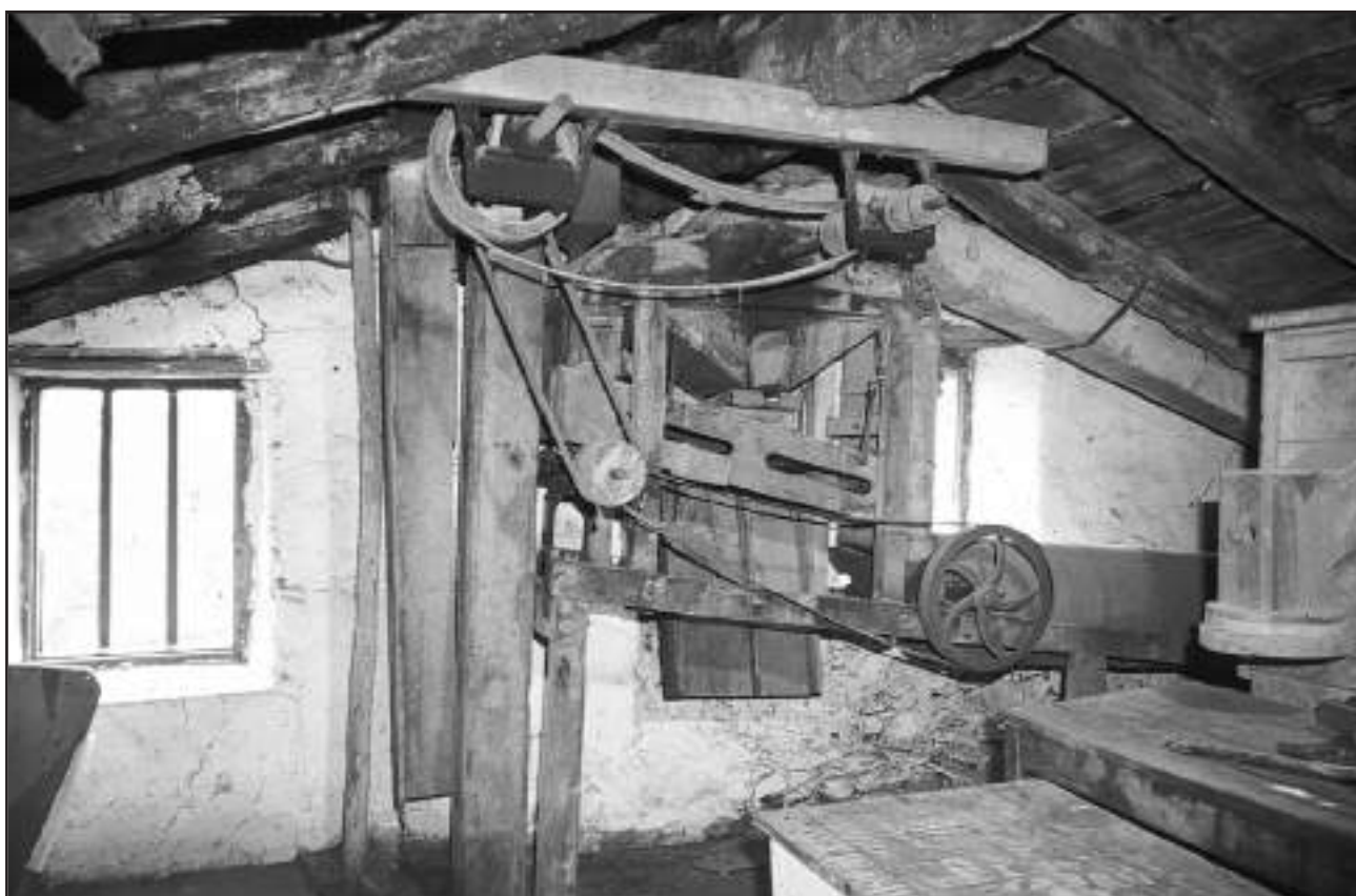
Igartzako Errota. Monitor de Limpia y triarbejón
