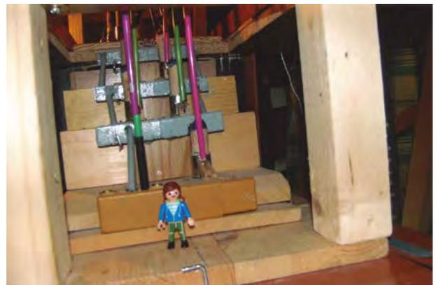
Vista total y de frente del edificio en cota de -10 m más los escalones de los 5 arietes de recuperación y en el escalón inferior la bomba eléctrica.
