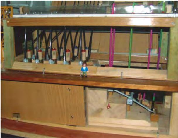
Vista del canal de cebado y depósito auxiliar de mantenimiento del caudal. Más parte de los arietes principales en cota; 000 de nivel
