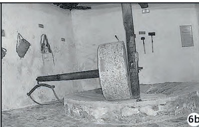
Esquemas de funcionamiento de un molino de chocolate a tracción de sangre. El punto A es el llamado timón, en donde se amarra al animal para que girara en círculo con la piedra. En la imagen n° 6b el "malakate" para fabricar chocolate.
